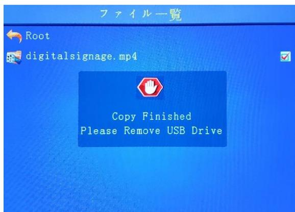
左の表示が出れば、内部基盤SDにコピーが完了です。本体側面のUSBを抜けば、コンテンツ変更が完了します。
